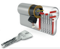
C 5 Profilzylinder, EU-Profil vernickelt 9-stiftig, Wendeschlüssel aus Neusilber. Schlüsselprofil ist geschützt und registriert. Anbohrschutz im Gehäuse und im Kern. Kernstifte aus rostfreiem Stahl. Gehäuseziehschutz. SICHERUNGSKARTE. DIN EN 1303:2015 BSI * SKG ** MPA geprüft
